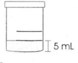
●Adicione 1 gota de Reagente 1 através do orifício da tampa, e misture cuidadosamente rodando o copo em pequenos círculos.
