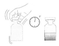
Remova a rolha, adicione 10 gotas do reagente 3, feche novamente e agite vigorosamente até todo o material estar dissolvido.
